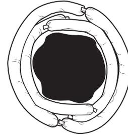
Saugstrümpfe überlappend um die Verschüttung legen. Bei großen Verschüttungen mehrere Lagen verwenden.
