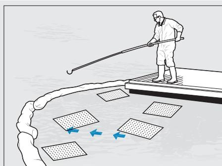
Ölsperren stromabwärts positionieren; dabei so locker legen, lassen, dass diese frei schwimmen, oder einen Winkel zur Stromrichtung bilden, um das Öl zu kanalisieren.
